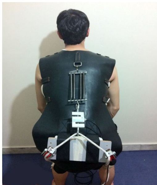
شکل ۱- نمای پشتی لباس کمکی برای برداشتن وزنه پوشیده شده توسط داوطلب
